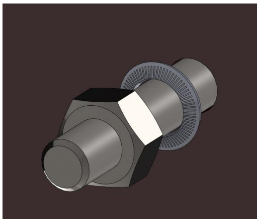
Falsch: lackiert / beschichtet
